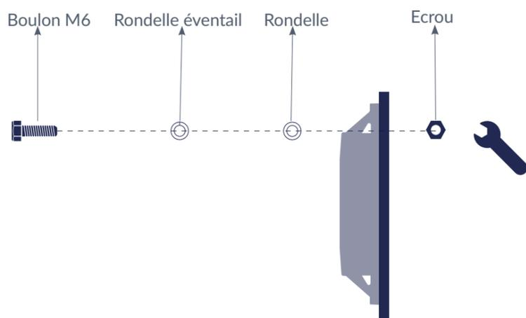
1. Utilisez les bonnes dimensions pour les boulons, il est recommandé d'utiliser le type M5 avec de la colle bloc écrou (par exemple Loctite).
